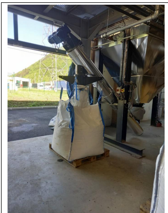
Vis d'évacuation des fines et collecte en big bag
